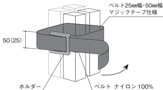
●物品固定用の結束ベルトはハサミでカットして、長さ調整ができます。
