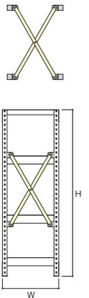
※背面・側面ブレースの追加により耐震強度アップ。(荷重条件やラックのサイズにより仕様は異なります。)
