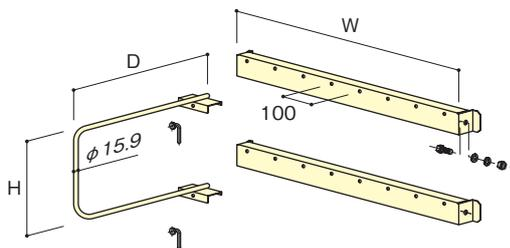
※取付け最小ピッチは仕切高さH+200mm以上です。(最上段は272mm)
